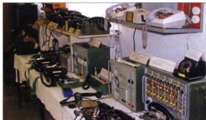
Fernsprechtechnik der Polizei (v. l. n. r. oben): 10er-Klappenschrank, diverse Feldfernsprecher und Diensttelefone; unten: Feldfernsprecher DVG-10, KSS 10, OB-62M, AS-60
