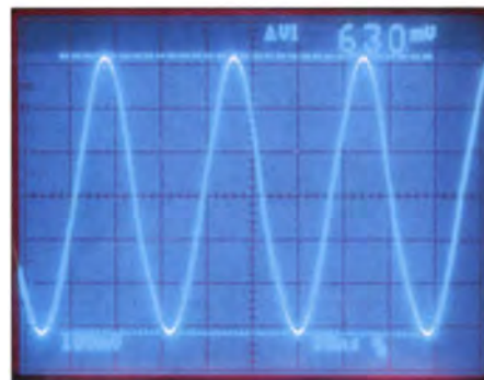
Bild 3: HF-Ausgangsspannung ( U_{ss} ) des Senders bei Einton-Aussteuerung auf einem Oszilloskop dargestellt, hier auf das HF-Signal synchronisiert
