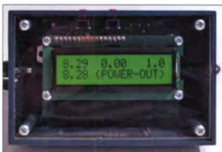
Bild 12: SWV-Meter, Anzeigewert: 8,29 W PEP, SWV s = 1,0 Fotos: DC4KU
