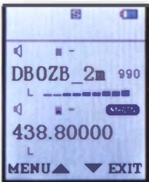
Anzeige von zwei parallel empfangbaren Frequenzen, einmal mit Speicherplatznamen und einmal mit der Frequenz
