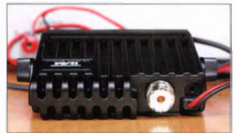
Kühlrippen auf der Rückseite des MiniCom
