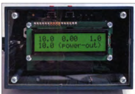
Bild 2: SWV-Meter, Anzeigewert P = 10 \text{ W} (PEP), SWV_s = 1,0
