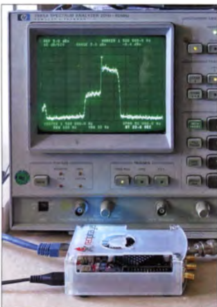
Bild 1: Das Red-Pitaya-Board erzeugt hier ein SSB-Signal mit Restträger und nicht vollständig unterdrücktem unteren Seitenband.
