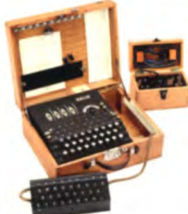
Chiffriermaschine »Enigma (K-Model)« mit zusätzlichem Fernlesegerät, um 1939
