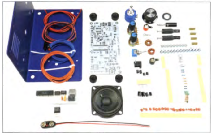
Bild 4: Der Einsteigerbausatz für den KW-Doppelsuper Junior 1 enthält sämtliche Bauelemente, eine Platine mit Bestückungsdruck, einen bearbeiteten und beschrifteten Gehäusewinkel sowie eine ausführliche Bauanleitung.
