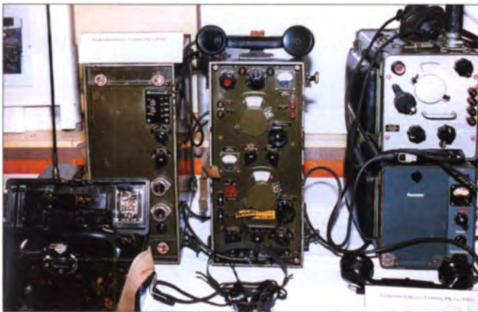
KW-Funkstation FK-50 (1954), bestehend aus Empfänger EK4L, Sender FK-50L, Schaltpult, Antennenanpass- und 220-V-Netzanschlussgerät
