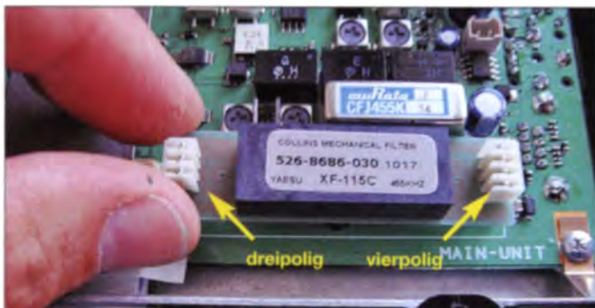
Bild 1: Korrekt auf der Hauptplatine positioniertes CW-Filter vor dem Aufstecken
