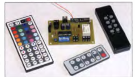
Mit dem fernsteuerbaren Universalschalter wurde eine Möglichkeit geschaffen, Schaltvorgänge leicht an eigene Anwendungsfälle anzupassen; der geplante Bausatz wird eine professionelle Leiterplatte enthalten. Foto: Pöggel
