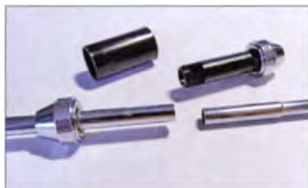
Durchgeschnittene Antenne mit Spulenattrappe, Endstücken und Schutzrohr
