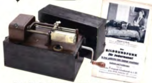
Das 1. Fax-Gerät der Welt: Bildfunk-Empfänger »The Fultograph«, um 1925
