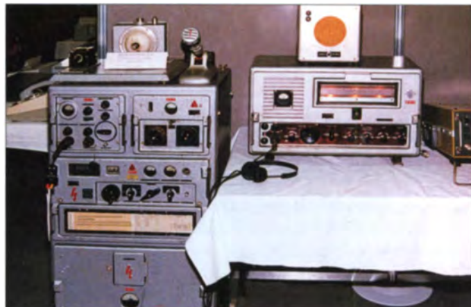
Die Funkstation aus 100-W-Grenz-/ Kurzwellensender und Empfänger Dabendorf war ursprünglich als Seefunkanlage konzipiert.
