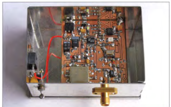
Bild 4: Ein fertiger PLL-Oszillator für 3256 MHz auf Basis eines Moduls von DF9NP
