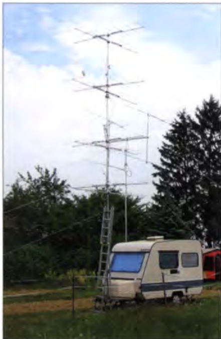
Bild 1: Yagi-Gruppe mit 4 x 4 Elementen, die Peter Stöcklin, DK3CM, aufbaute
