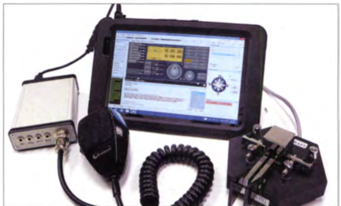
Der Client, installiert auf einem Windows-Tablet mit ORB-Control-Device, Handmikrofon und Paddle Fotos: HB9AZT (2), Werkfoto (1) Screenshots: HB9AZT
