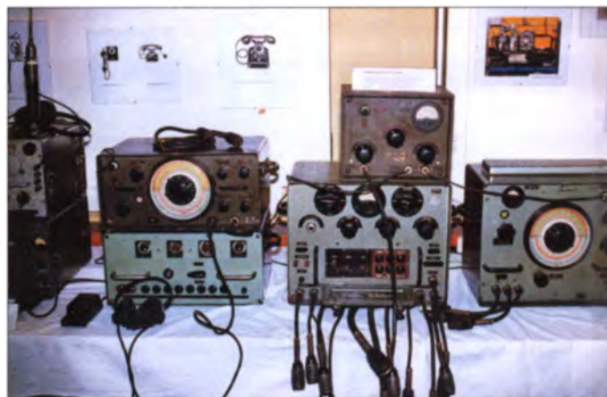
KW-Funkstation FK-50 (1954), bestehend aus Empfänger EK4L, Sender FK-50L, Schaltpult, Antennenanpass- und 220-V-Netzanschlussgerät
