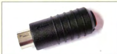
Diese Abstimmhilfe ist lediglich in die freie CAT-Buchse eines Yaesu-Transceivers zu stecken.
