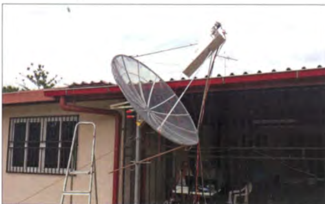
Der bei PZ5HP für die höheren Bänder verwendete 1,5-m-Spiegel; im Hintergrund ist DL4WO im Shack zu erkennen.
