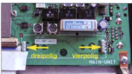
Bild 2: Freier Steckplatz für das CW-Filter auf der Hauptplatine Fotos: OE5HIL
