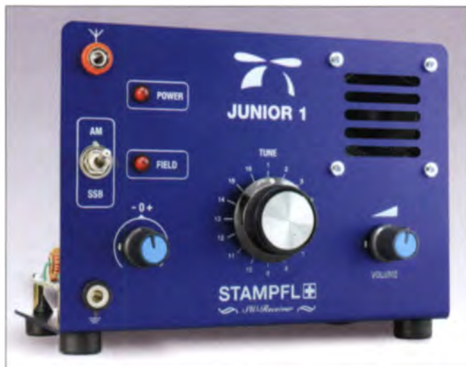
Bild 1: Frontansicht des fertig aufgebauten Junior 1; in der Mitte ist der Hauptabstimmknopf zu sehen, links daneben die Feinabstimmung und rechts der Lautstärkesteller.
