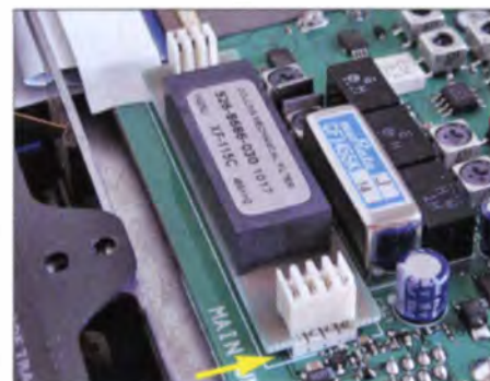
Bild 3: Die Filterplatine darf nur auf den Steckverbindern und nicht direkt auf der Hauptplatine liegen.
