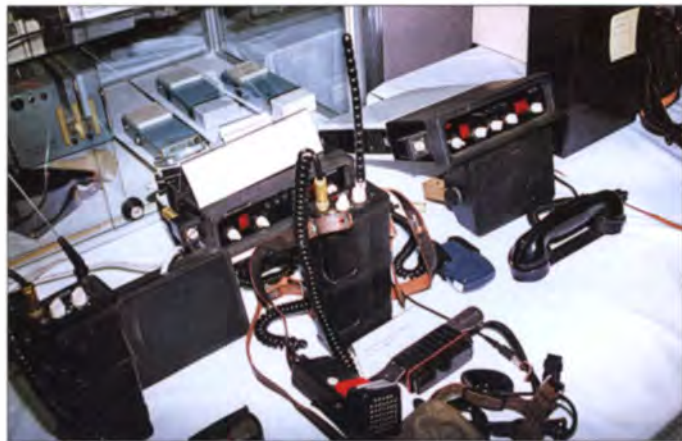
Die Funkstation aus 100-W-Grenz-/ Kurzwellensender und Empfänger Dabendorf war ursprünglich als Seefunkanlage konzipiert.
