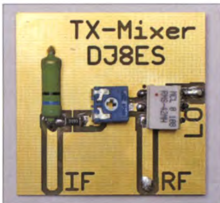
Bild 8: Der Sendemischer mit einstellbarem Dämpfungsglied für den ZF-Pegel
