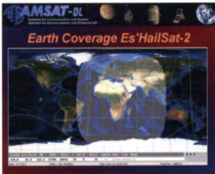
Der Amateurfunk-Satellit soll etwa ein Drittel der Erdoberfläche ausleuchten. Bild: AMSAT-DL
