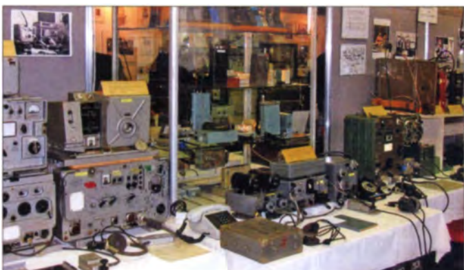
Die Bereitschaftspolizei der DDR setzte auch militärische Funktechnik aus sowjetischer Produktion ein (v.l.n.r: R-130, R-111, 10RT-26, R-104M, R-105-D).
