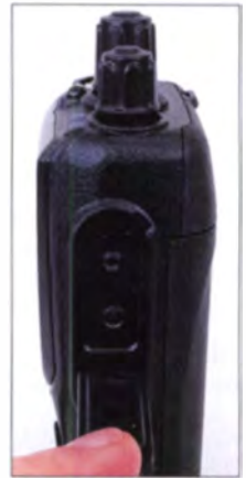
Klinkenbuchsen dienen als NF-Anschluss oder für ein Programmierkabel.
