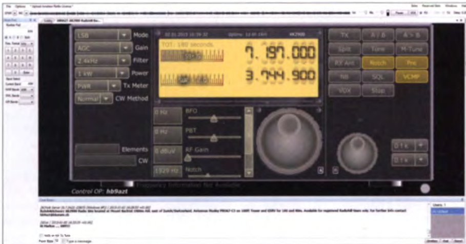
Blick auf die Benutzeroberfläche des Clients für einen R&S XK2900-Transceiver
