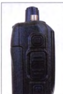
Als Antennenanschluss fungiert nun eine Standard-SMA-Buchse.
