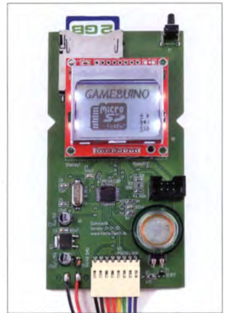
Bild 2: Vollständig bestückte Leiterplatte des Duinocade im Test Fotos: Wendt
