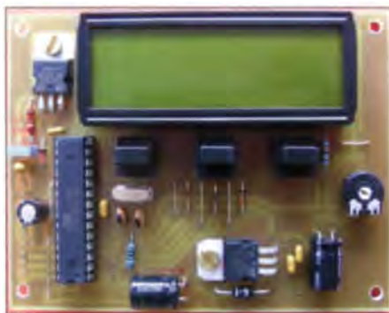
Mit dem Photometer AS535 wurde ein hochwertiges Messgerät geschaffen, das kommerziellen Geräten kaum nachsteht. Der Einsatz verschiedener LEDs ist innovativ. Die Bauanleitung und ein Beitrag zum richtigen Einsatz befinden sich im Praxisheft 25. Foto: DL50AU
