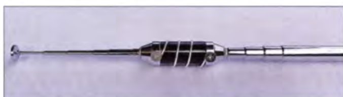
Durchgeschnittene Antenne mit Spulenattrappe, Endstücken und Schutzrohr
